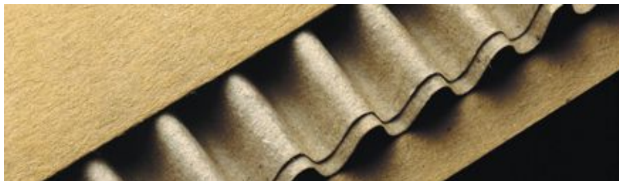
FIGURA 16– Estrutura do papelão ondulado
