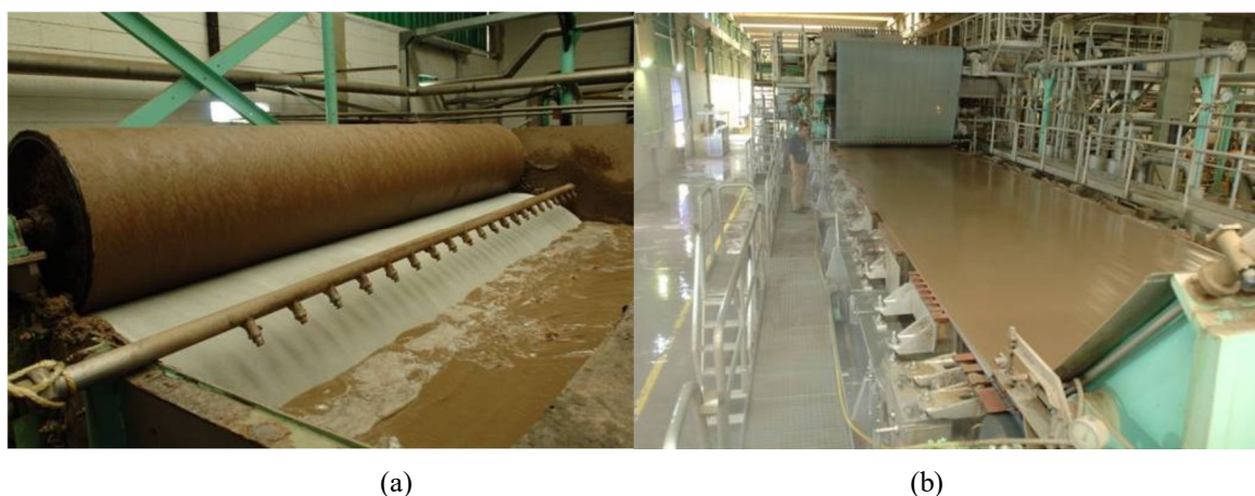
FIGURA 12– (a) Preparo da massa e (b) Formação da folha de papel
