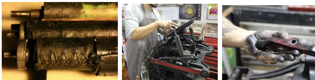
Figura 35: Antiga rolaria e restauração da prensa. Fonte: Acervo do autor.
