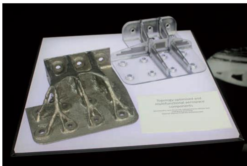
Figura 43: Componentes aeroespaciais topologicamente otimizados, pela Universidade de Loughborough, fabricada pelo processo SLM em liga de titânio (Ti/6Al/4V). Fonte: (BROOKES, 2014)
