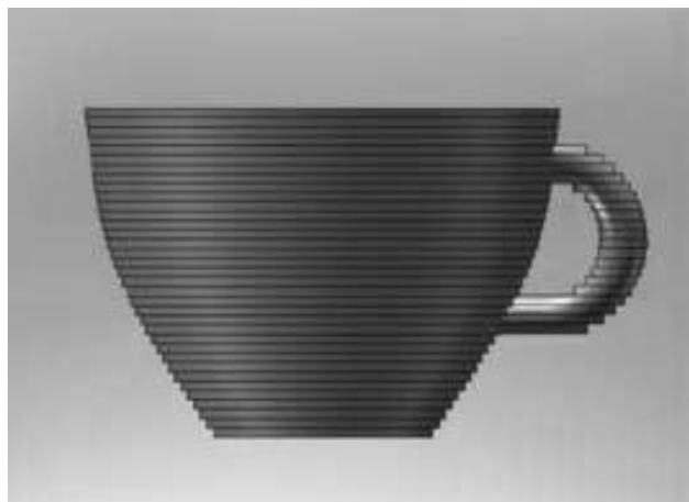
Figura 8 - Imagem de uma xícara mostrando as camadas construtivas Fonte: (GIBSON, ROSEN e STUCKER, 2010)
