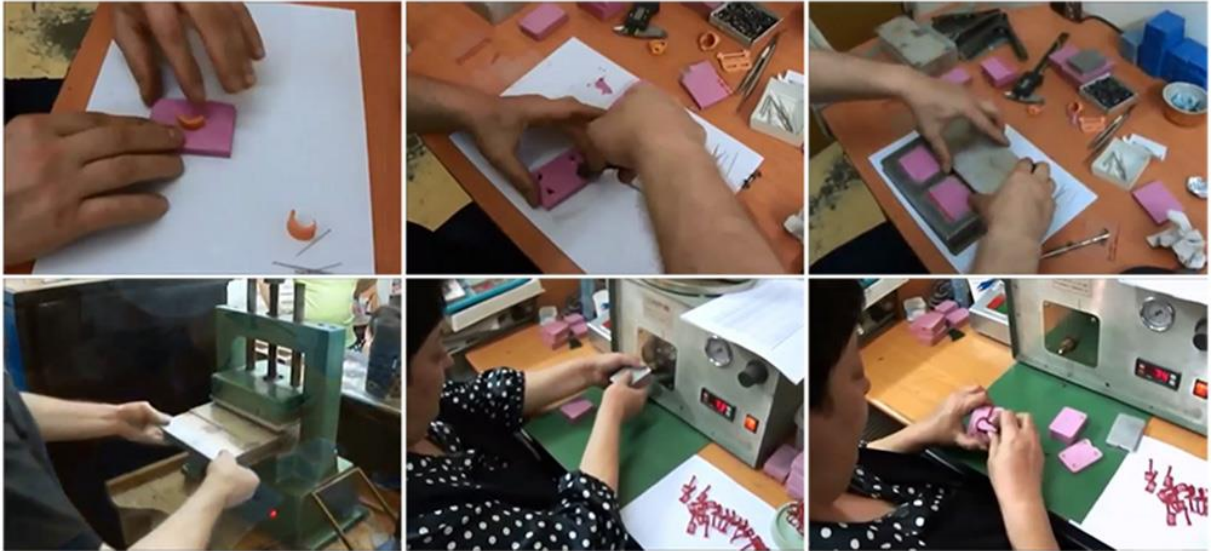
Figura 36 - Etapas e técnica de construção de molde de borracha e injeção de peças em cera Fonte: (EOS, 2015)
