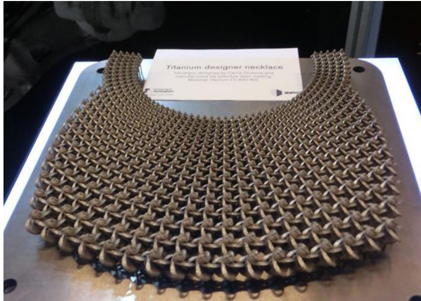
Figura 45: Colar em liga de titânio criado pelo designer Carrie Dickens feito em uma única etapa por manufatura aditiva.
