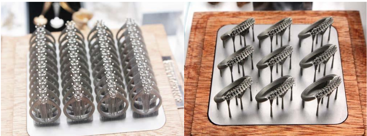
Figura 44: 40 anéis em metal precioso feitos simultaneamente em uma só etapa à esquerda, e anéis mais complexos em lotes menores, porém com menos suportes de material à direita. Fonte: (BROOKES, 2014)
