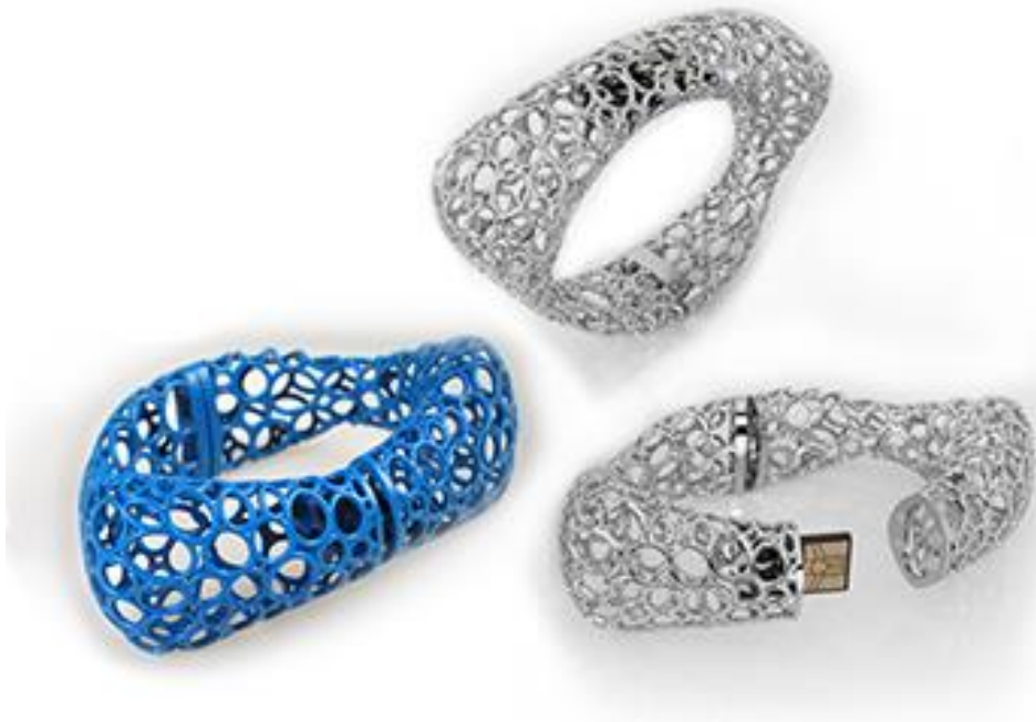
Figura 34 - Bracelete em cera fabricado em manufatura aditiva e posteriormente fundido em prata Fonte: (SOLIDSCAPE, 2014)
