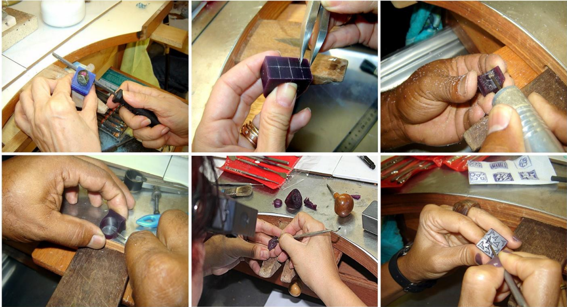
Figura 32 - Imagens de modelagem de anel feita em cera Fonte: (ESPAÇO RITA SANTOS, 2014)
