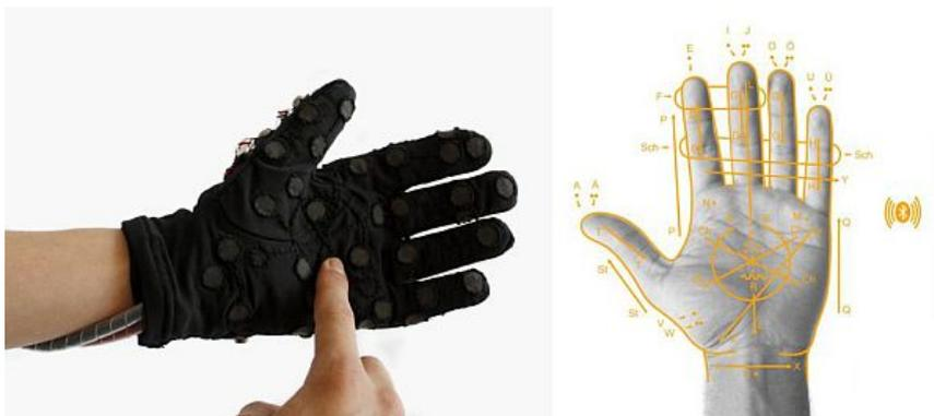
FIGURA 38 – Relação entre os sensores da *'Mobile Lorm Glove'* e os sinais em *'Lorm'*.
