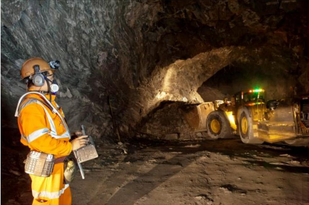
Figura 76: Carregamento mecanizado do minério extraído
