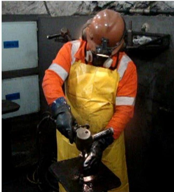
Figura 84: Afiação manual de bit de perfuração
