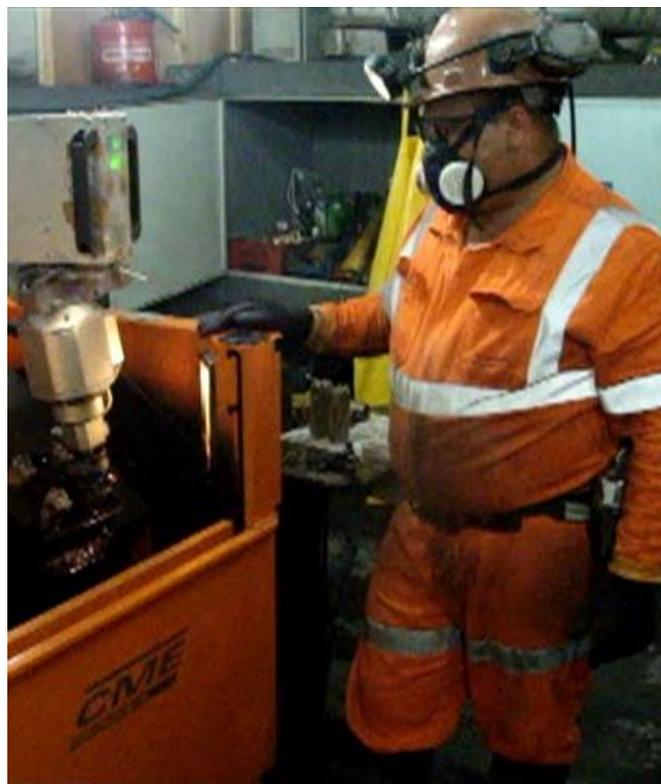
Figura 85: Afiação automatizada de bit de perfuração
