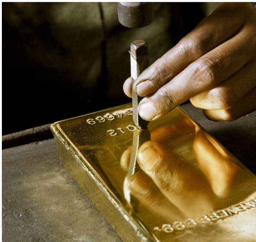
Figura 87: Marcação da barra de ouro da AGACSM
