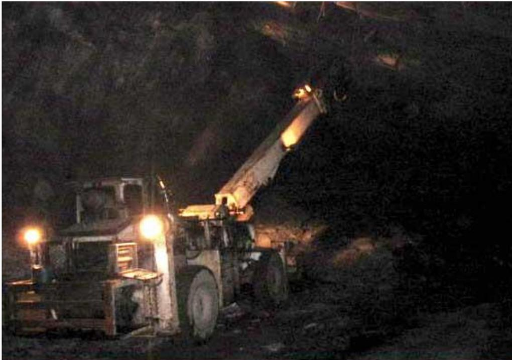
Figura 74: Saneamento mecanizada (Scaler)
