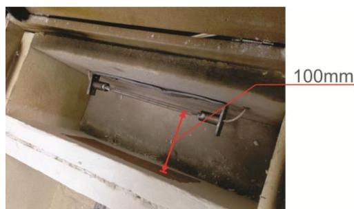
Posicionado no mesmo local durante todos os ensaios, o relógio termo-higrômetro registrou a temperatura atmosférica e a umidade do ar. A lente da termocâmera, por sua vez, foi centralizada com o túnel e disposta a 900mm da face externa do bloco (Fig. 31). Essa distância foi estipulada empiricamente<sup>25</sup> e se manteve constante em todos os ensaios da terceira etapa.
