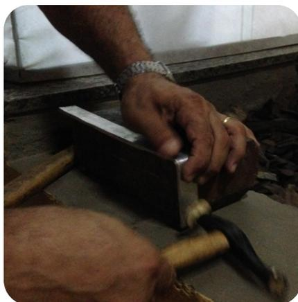
Utilizar bloco de metal para modelagem e martelo para funileiro para dobrar o ferro chato para conformar o suporte.
