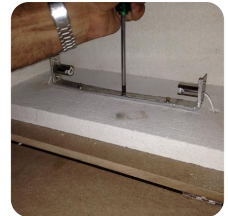
Fixação do suporte com soquetes no fundo do túnel com chave Philips nº2 e três parafusos rosca soberba 4x16mm.
