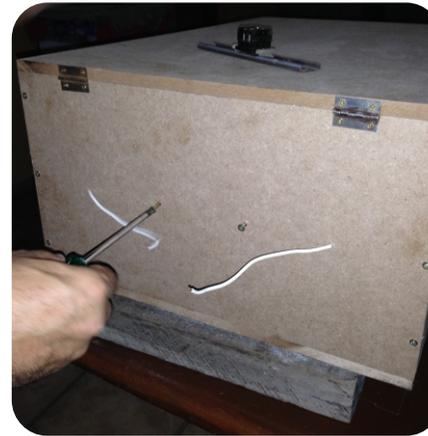
Furação com chave de fenda 1/4" ou Philips nº2 para instalação do conector Sindal, para alimentação da lâmpada.
