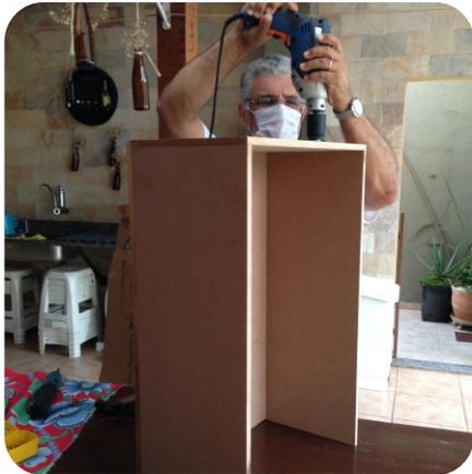
Fixação da placa posterior (ver PR02/06) utilizando furadeira com broca AR 1/8" e parafusadeira com Philips nº2.
