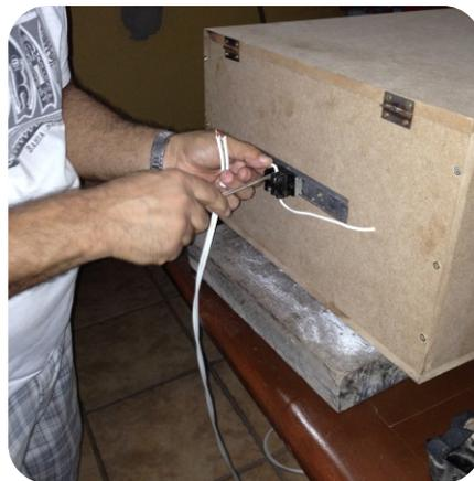
Instalação do cabo para energização da lâmpada. Utilizar tomada 110V.
