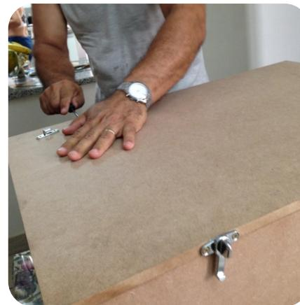
Instalação de quatro trincos de pressão por alavanca para fixação do tampo no corpo da caixa.
