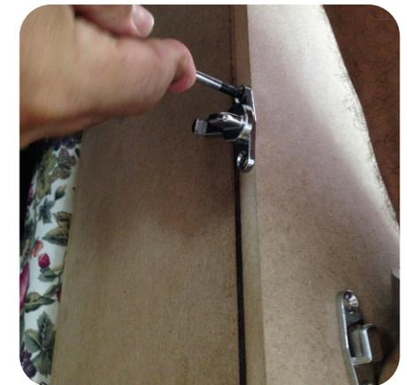
Fixação do trinco de pressão por alavanca com chave Philips nº2.
