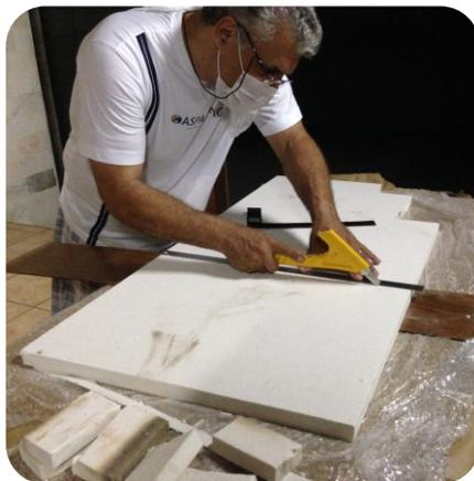
Placa isolante AT-1200, 25.4mm, sendo cortada com estilete (faca Olfa), esquadro graduado e régua de aço.
