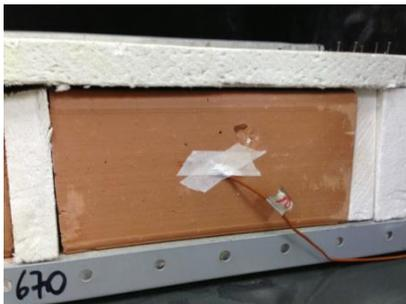
Fixação da haste do termopar na face externa do bloco
