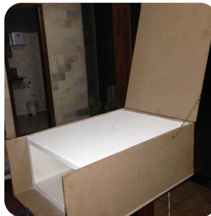
Revestimento interno com placa isolante cortada em 2 peças de 59x45cm (tampo e base), 2 de 59x19.9cm (laterais) e 1 de 39.9x19.9cm (fundo). Peças encaixadas.
