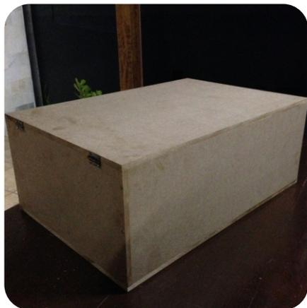
Caixa em formato de túnel montada e pronta para instalação das placas isolantes.
