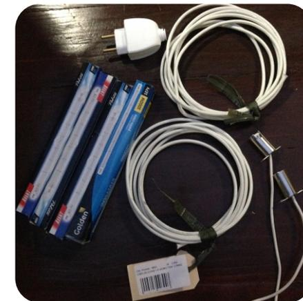
Lâmpadas halógena palito de 1000W, cabo de silicone com fibra de vidro, soquetes para lâmpada e plugue/tomada.
