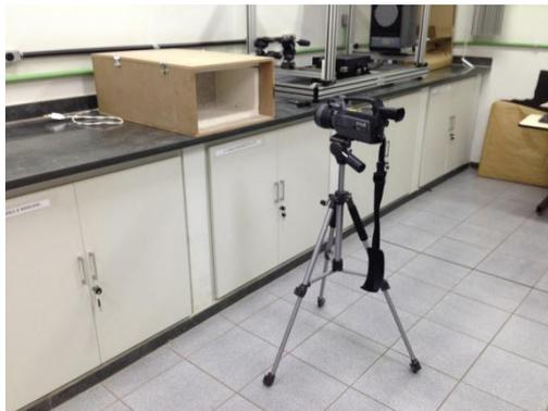
Para a análise dos termogramas, foi necessário conhecer a emissividade da cerâmica e do concreto. Dessa forma, tais valores foram estimados pela técnica da emissividade conhecida, conforme descrito no item 4.2.2.2.
