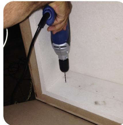
Furação do fundo do túnel (placa isolante e MDF) para passagem dos cabos condutores e para fixação do suporte.
