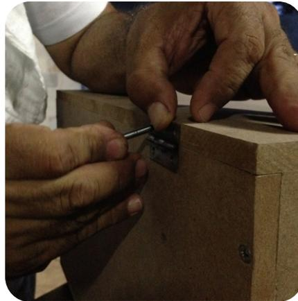
Marcação para fixação da dobradiça metálica 2"x3/4".
