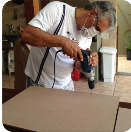
Furação da base conforme marcação apresentada na PR 02/06. Utilizar furadeira com broca AR 1/8".
