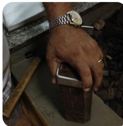
Utilizar bloco de metal para modelagem e martelo para funileiro para dobrar o ferro chato para conformar o suporte.
