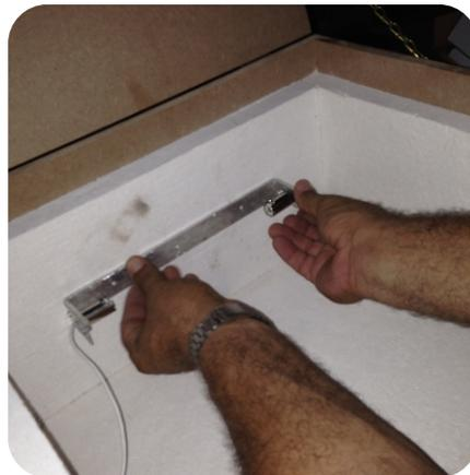
Verificando posicionamento para fiação do suporte de ferro chato no fundo da caixa. O suporte deve estar centralizado.
