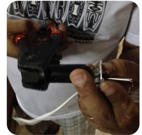
Utilizar alicate e arrebite pop de 1/8"x6mm para fixação do soquete no suporte de ferro chato.
