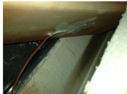
Fixação da haste do termopar na face interna do bloco
