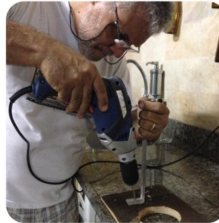
Furações em cada lado do suporte para instalação dos soquetes: um furo central de 5mm e dois de 1/8" de acordo com as furações do soquete.
