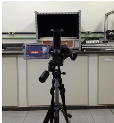
Para a leitura dos valores de temperatura, como apresentado no item 3.3.3, a termocâmera deve ser configurada com os valores de temperatura ambiente, umidade do ar, distância entre a lente e o objeto ensaiado, temperatura refletida e emissividade do material em análise.
