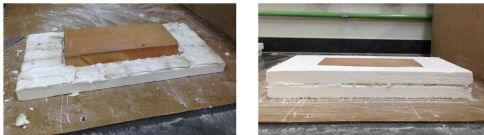
Na abertura frontal da caixa colocou-se o bloco a ser ensaiado, a uma distância de 100mm do eixo da lâmpada (Fig. 30). Essa distância foi estipulada com base no primeiro ensaio e se manteve constante em todos os ensaios da terceira etapa.
